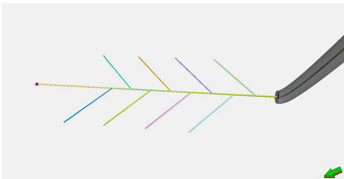
Рисунок 4.8 – Модель скважины типа «Fishbone» с восемью боковыми ответвлениями
