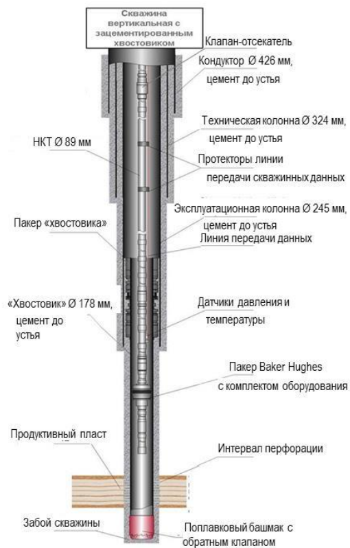
Рисунок 3 – Конструкция вертикальной скважины ачимовских отложений
