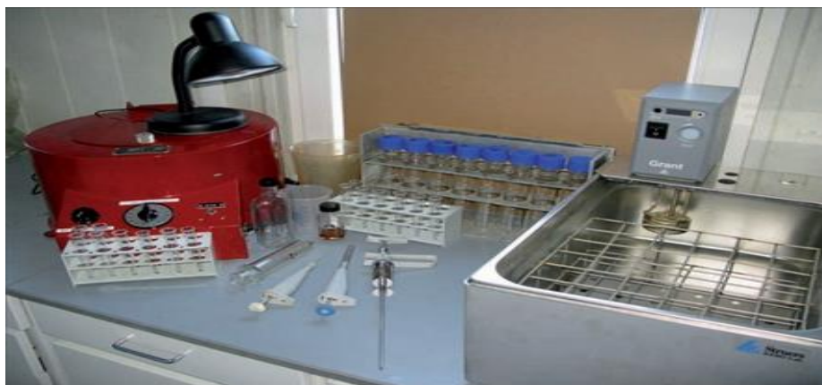
Рисунок 3.5 – оборудование для лабораторных испытаний деэмульгаторов
