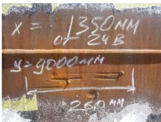
Рисунок 17 – Задиры поверхности стенки
