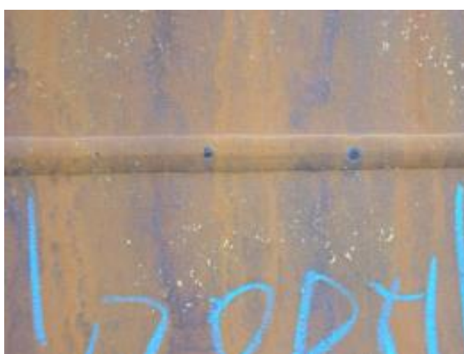
Рисунок 19 – Одиночные газовые поры
