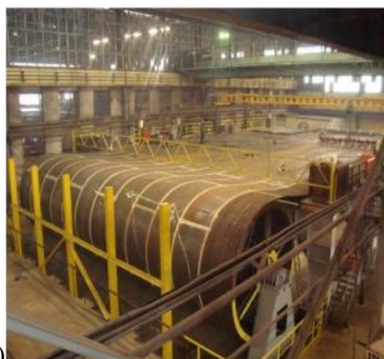
Рисунок 7 – Стенды рулонирования: а) одноярусный стенд, б) двухъярусный стенд
