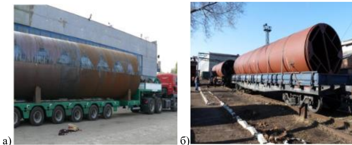
Рисунок 8 – Транспортировка рулонных заготовок для конструкции резервуара: а) автомобильный транспорт, б) железнодорожный транспорт
