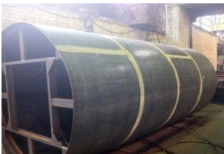
Рисунок 5 – Подготовленное полотно для стенки резервуара в виде рулона
