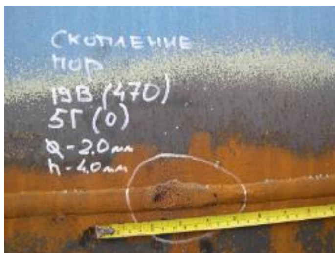
Рисунок 20 – Скопление газовых пор
