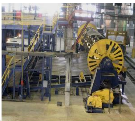
Рисунок 7 – Стенды рулонирования: а) одноярусный стенд, б) двухъярусный стенд
