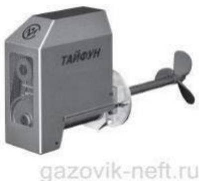
Устройство и принцип работы: Принцип работы изделий Тайфун заключается в образовании и направленной затопленной струи нефти или нефтепродукта, создаваемой пропеллером при его возвратно-угловом движении над дном резервуара.
