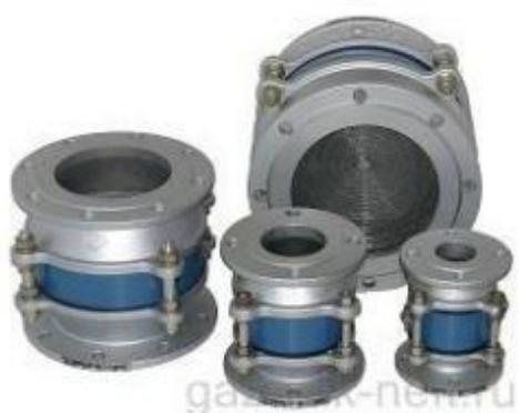
Устройство и принцип работы: Принцип действия ОП основан на задержке пламени кассетой. Кассета состоит из пакета чередующихся гофрированных и плоских пластин, образующих каналы малого диаметра. Пламя, попадая в каналы малого сечения, дробится на отдельные мелкие потоки.
