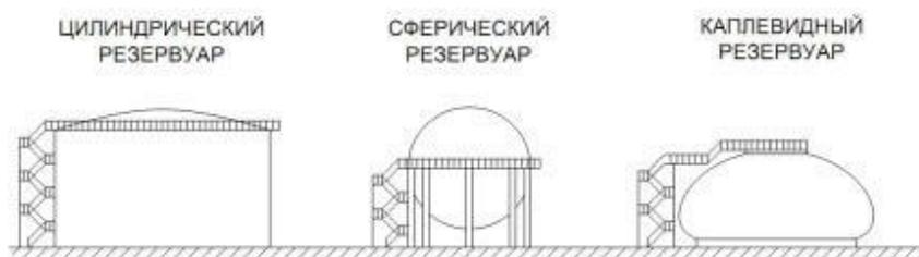
Рис. 3. Разновидность корпусов резервуаров [3]
