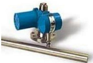
Принцип действия: На тонущий боек действует в соответствии с законом Архимеда выталкивающая сила, пропорциональная степени погружения и, соответственно, уровню жидкости. Действие этой силы воспринимает тензопреобразователь (уровнемеры типа Сапфир -ДУ), либо индуктивный преобразователь (УБ-ЭМ), либо заслонка, перекрывающая сопло (пневматические уровнемеры типа ПИУП)
