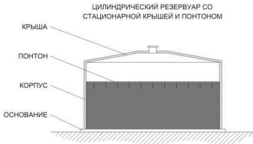
Рис. 4 Цилиндрический резервуар со стационарной крышей и понтоном [3]
