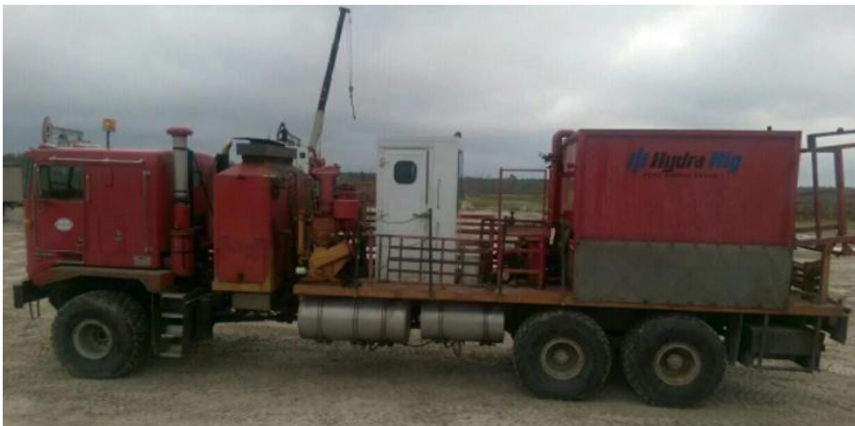
Рисунок 6 - Насосно-компрессорный агрегат производства компании NOV HydraRig [11]
