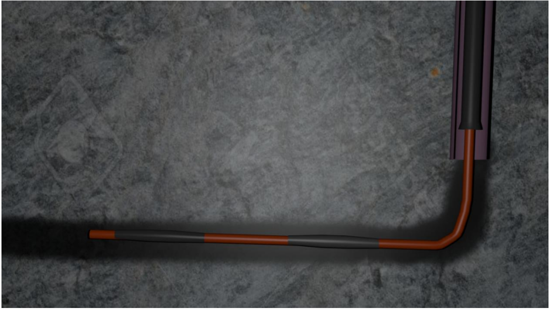
Рисунок 8 – Спуск компоновки ГНКТ в заданный интервал [8]
