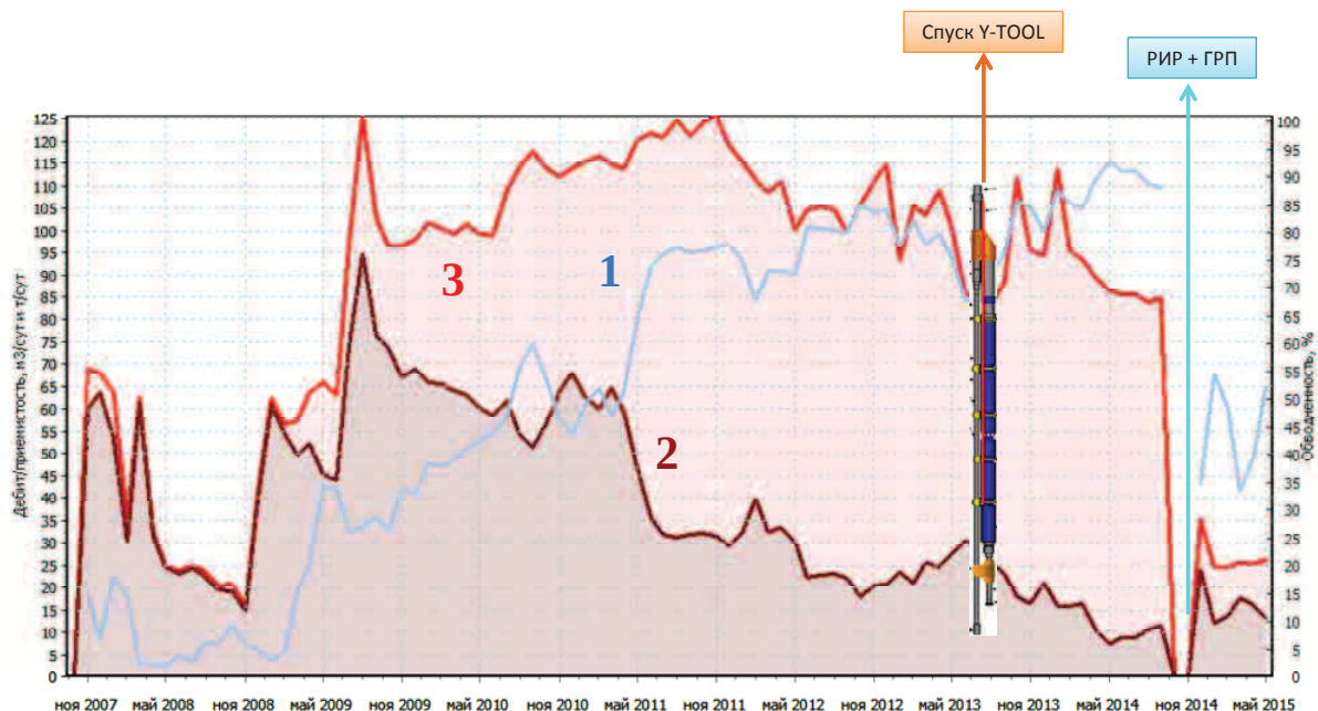
Рис. 3. История работы скважины 15 ''' . 1 – обводненность; 2 – дебит нефти; 3 – дебит жидкости. После изоляции верхнего выработанного пласта существенно уменьшилась обводненность продукции и возрос дебит нефти
