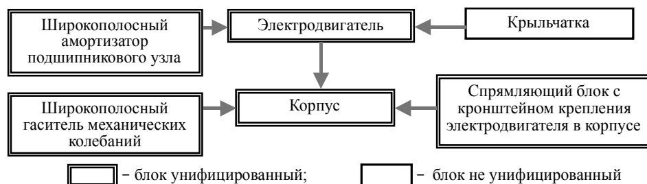
Рис. 8. Обобщенная структурная схема унификации осевого и радиального вентиляторов Fig. 8. Generalized block diagram of unification of the axial and radial fans
