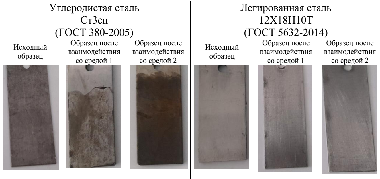
Рисунок 3.4.1.2 – Примеры образцов углеродистой и легированной сталей до и после испытаний
