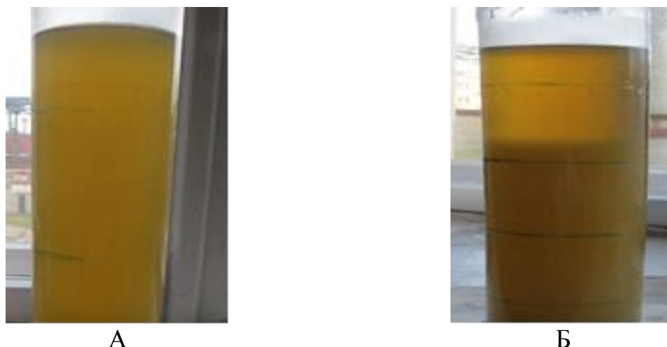
Рисунок 3.2.1 – Примеры визуальной оценки седиментационной устойчивости проб для стабильного (А) и нестабильного (Б) топлива
