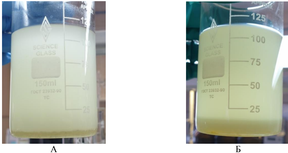
Рисунок 3.5.2.1 – Расслоение 20 мас.% раствора НМПЭ в ДТЛ при хранении
