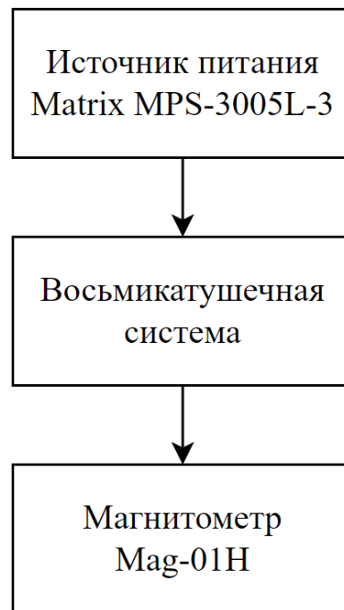
Рисунок 4.2 – Схема соединения установки для создания магнитного поля
