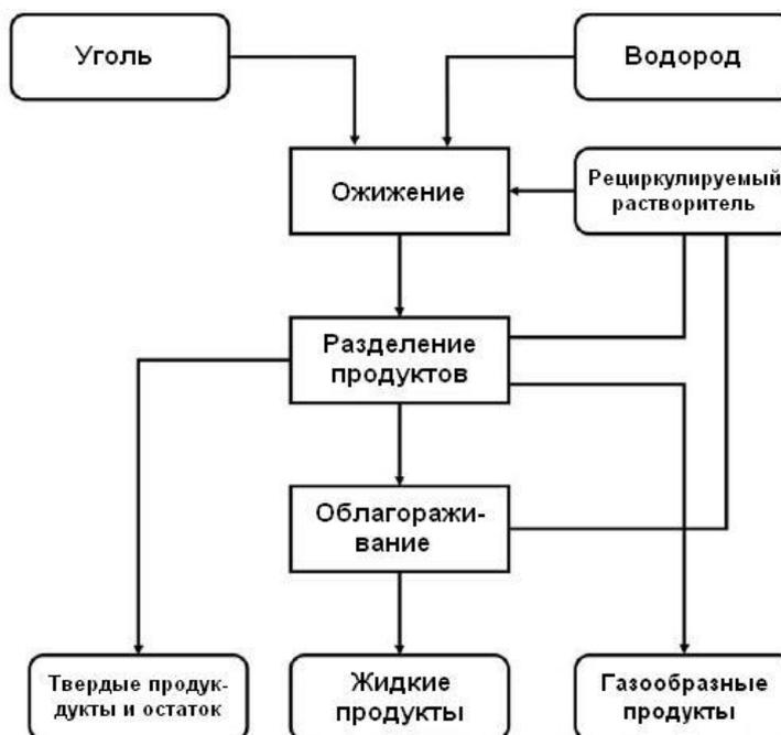
Рисунок 5. Ключевые стадии процессов прямого ожижения угля (DCL).
