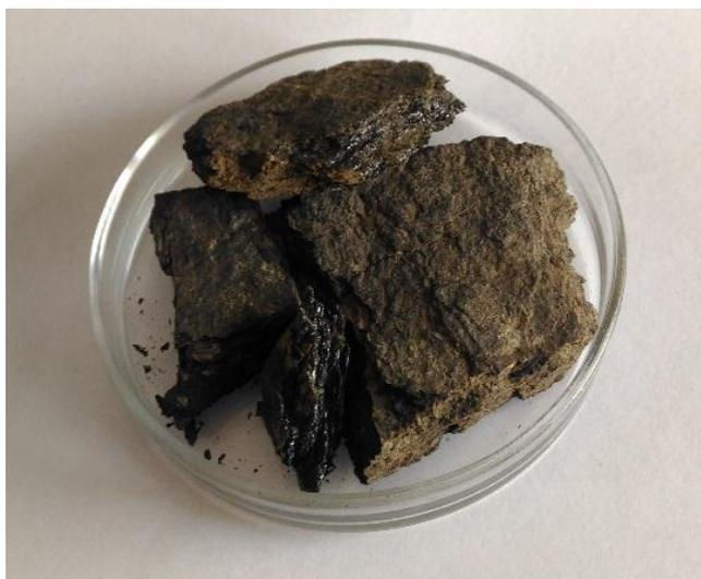
Рисунок 8. Плитчатая модификация барзасских углей
