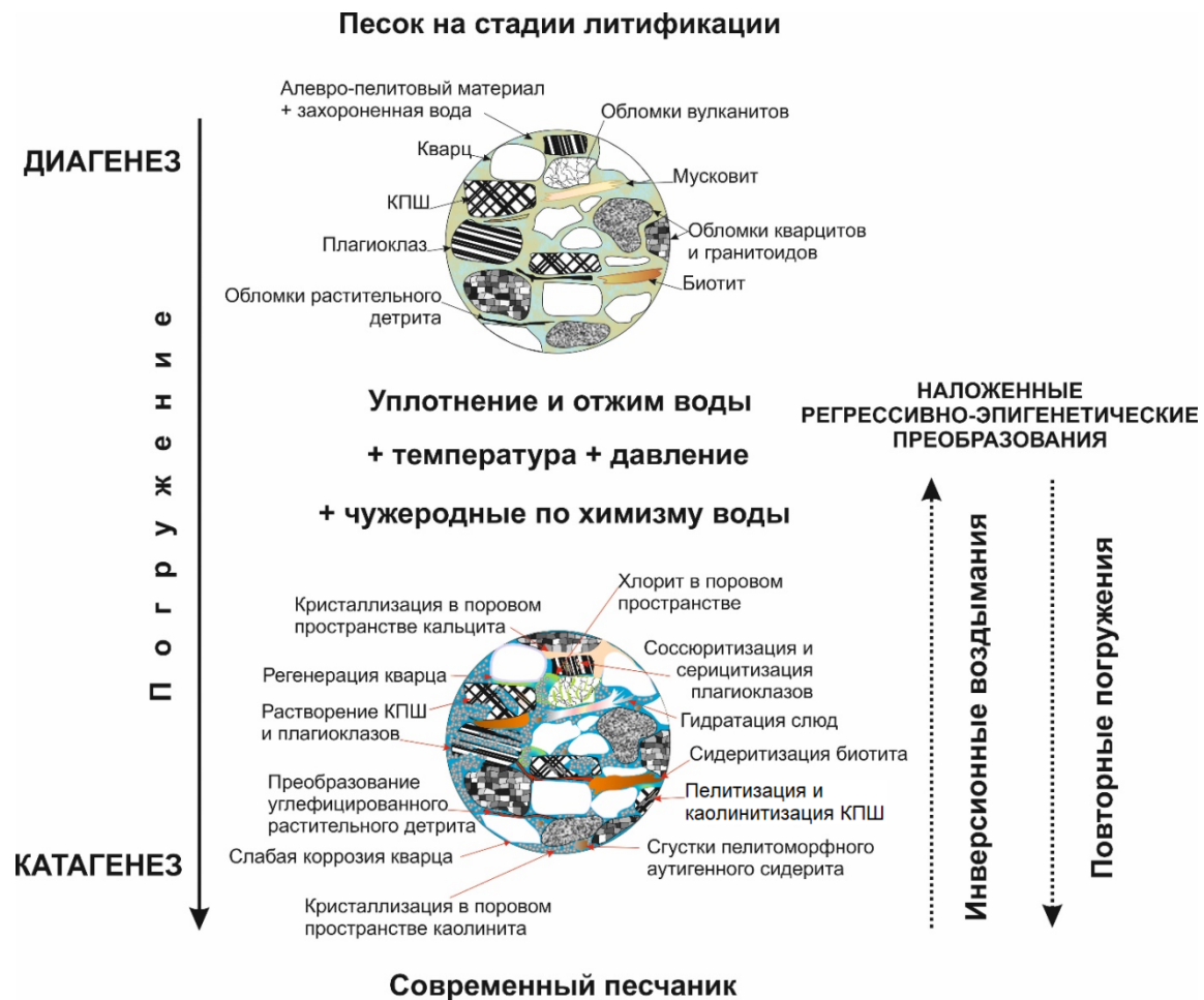
Рис. 10. Схема, отражающая процессы формирования песчаных коллекторов на Лодочном месторождении
