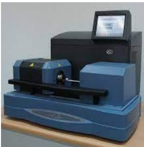
Рисунок 2.4 – Термоанализатор SDT Q600 производитель Thermo Electron Corporation (USA)
