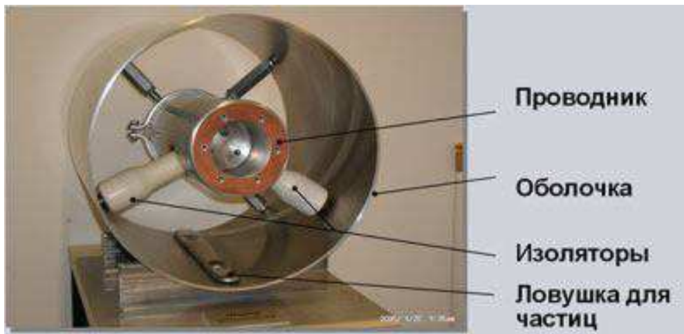
Рис. 2. Устройство газовой линии
