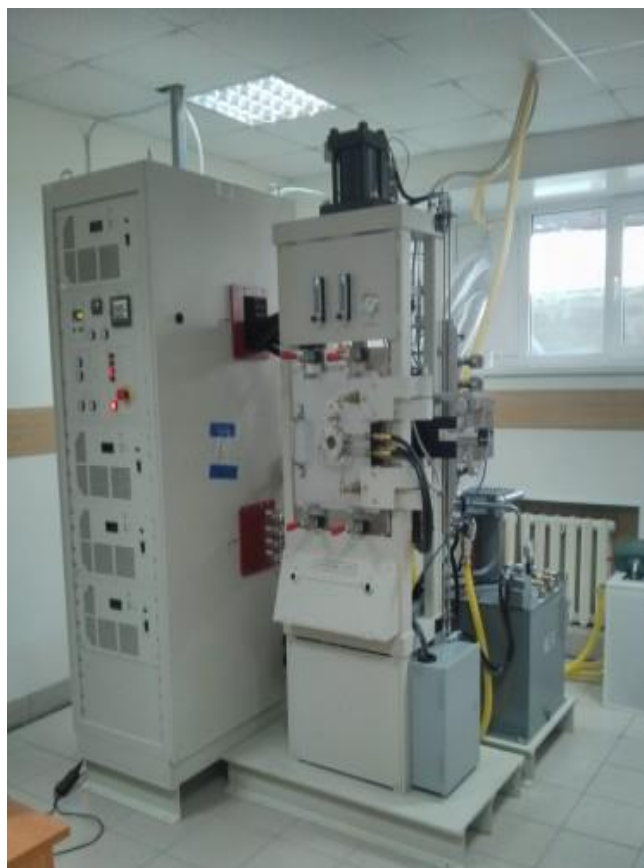
Рисунок 2.3 – Внешний вид установки искрового плазменного спекания SPS 10-4 (GT Advanced Technologies, США)
