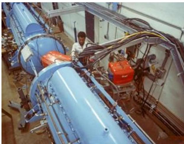
Рисунок 1.5. Национальная ускорительная лаборатория им. Э. Ферми (США). Изогнутый дипольный магнит направляет пучок в кабинет нейтронной терапии [7].
