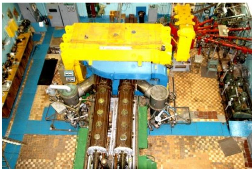
Рисунок 2.4. Внешний вид циклотрона У-120 ТПУ.
