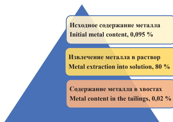
Рис. 3. Показатели выщелачивания урана в штабеле Fig. 3. Indicators of uranium leaching in the stack
