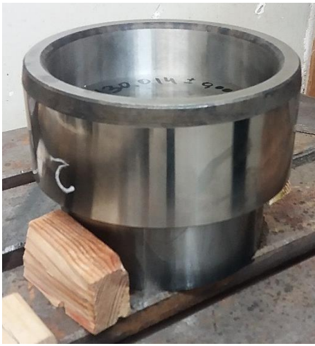
Рисунок 4.9 – Предварительная тепловая посадка колец подшипников на стальные болванки
