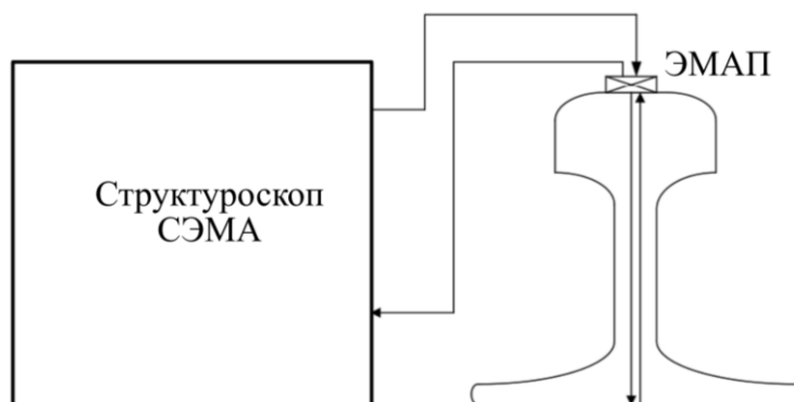
Рисунок 1.12 – Схема установки электромагнитно-акустического преобразователя (ЭМАП) на головке рельса и ход лучей [34]
