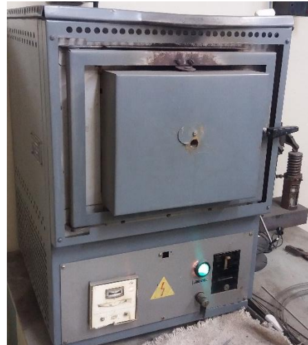
Рисунок 4.9 – Предварительная тепловая посадка колец подшипников на стальные болванки
