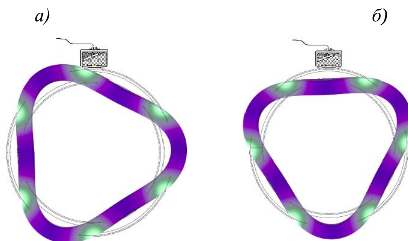
Рисунок 3.19 – Формы собственных колебаний кольца осевой симметрии одного n -го порядка: а) 4,601 кГц; б) 4,599 кГц
