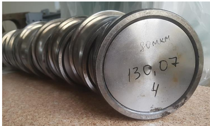
Рисунок 4.13 – Готовые соединения колец подшипников со стальными болванками
