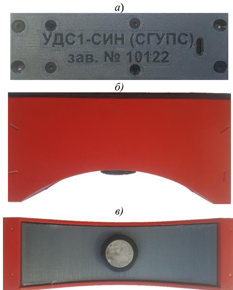
Рисунок 4.2 – Внешний вид прибора УДС1-СИН: а – вид сверху; б – вид сбоку; в – контактная поверхность
