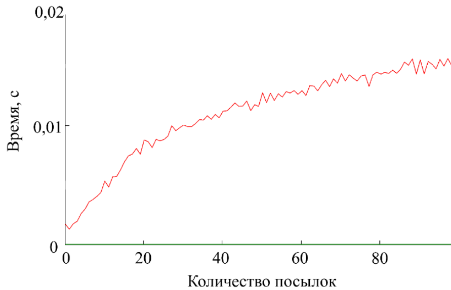
Рисунок 4.19 – Зависимости времени уменьшения амплитуды импульсов до порогового уровня от количества посылок для кольца, напрессованного на ось с гарантированным натягом
