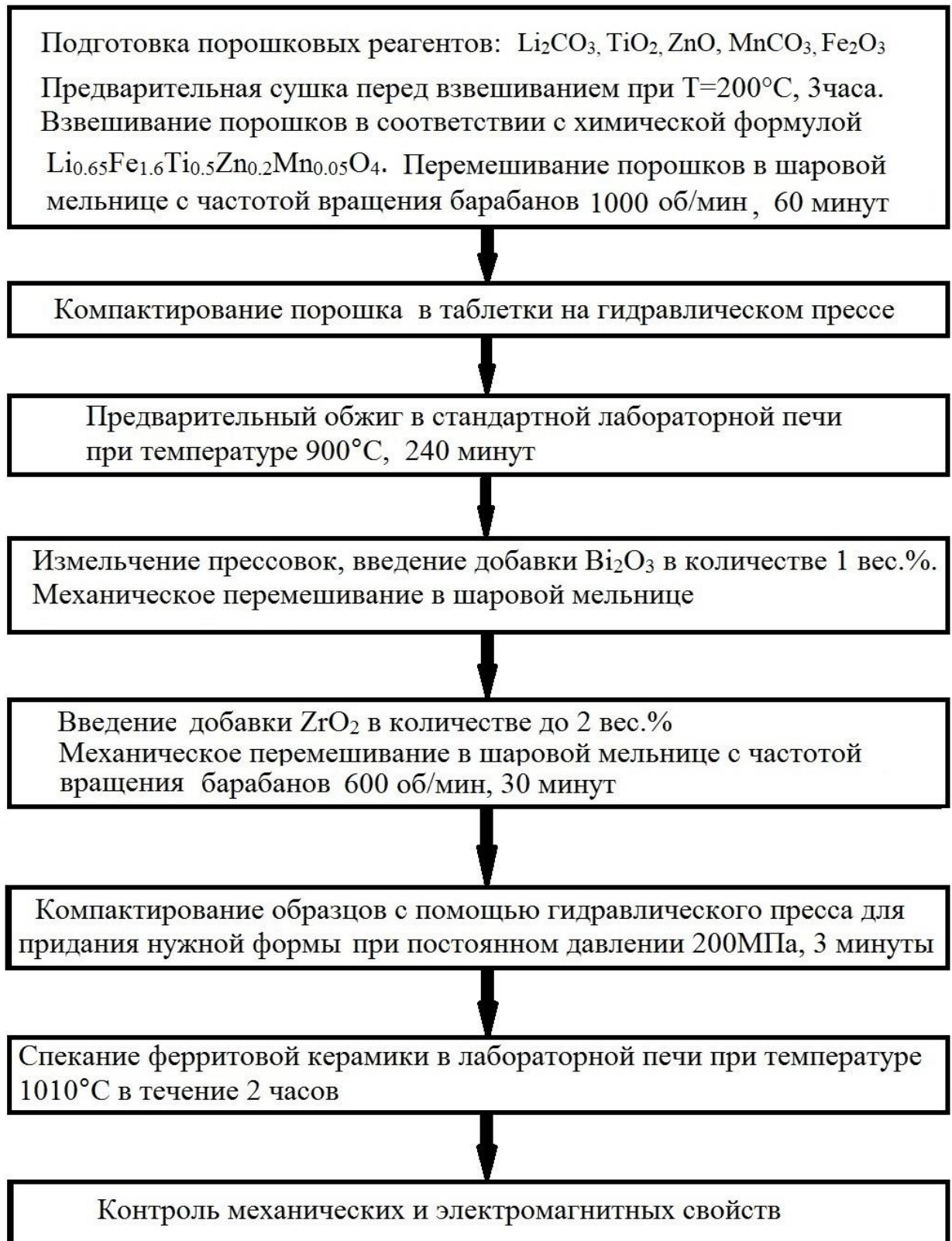
Рисунок 4.17 – Технологическая схема спекания Li-Ti-Zn-Mn феррита с добавкой \text{ZrO}_2
