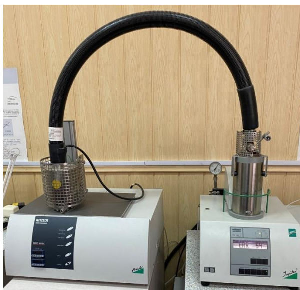
Рисунок 2.11 – Синхронный термический анализатор STA 449C Jupiter
