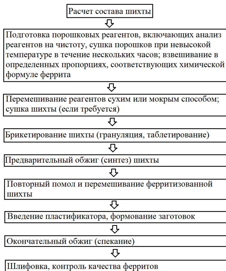
Рисунок 1.2 – Технологическая схема получения ферритов
