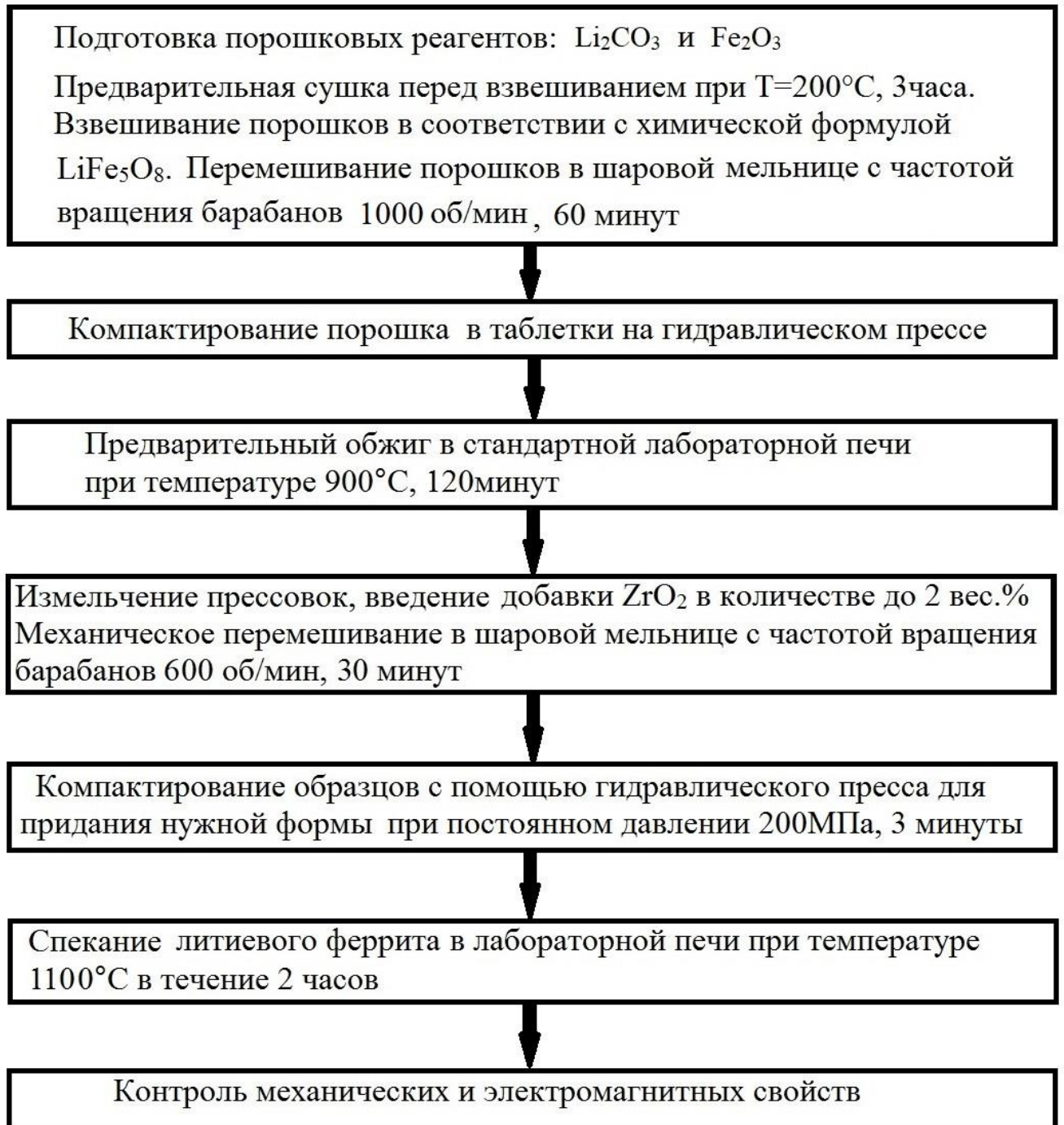
Рисунок 4.16 – Технологическая схема спекания Li феррита с добавкой \text{ZrO}_2
