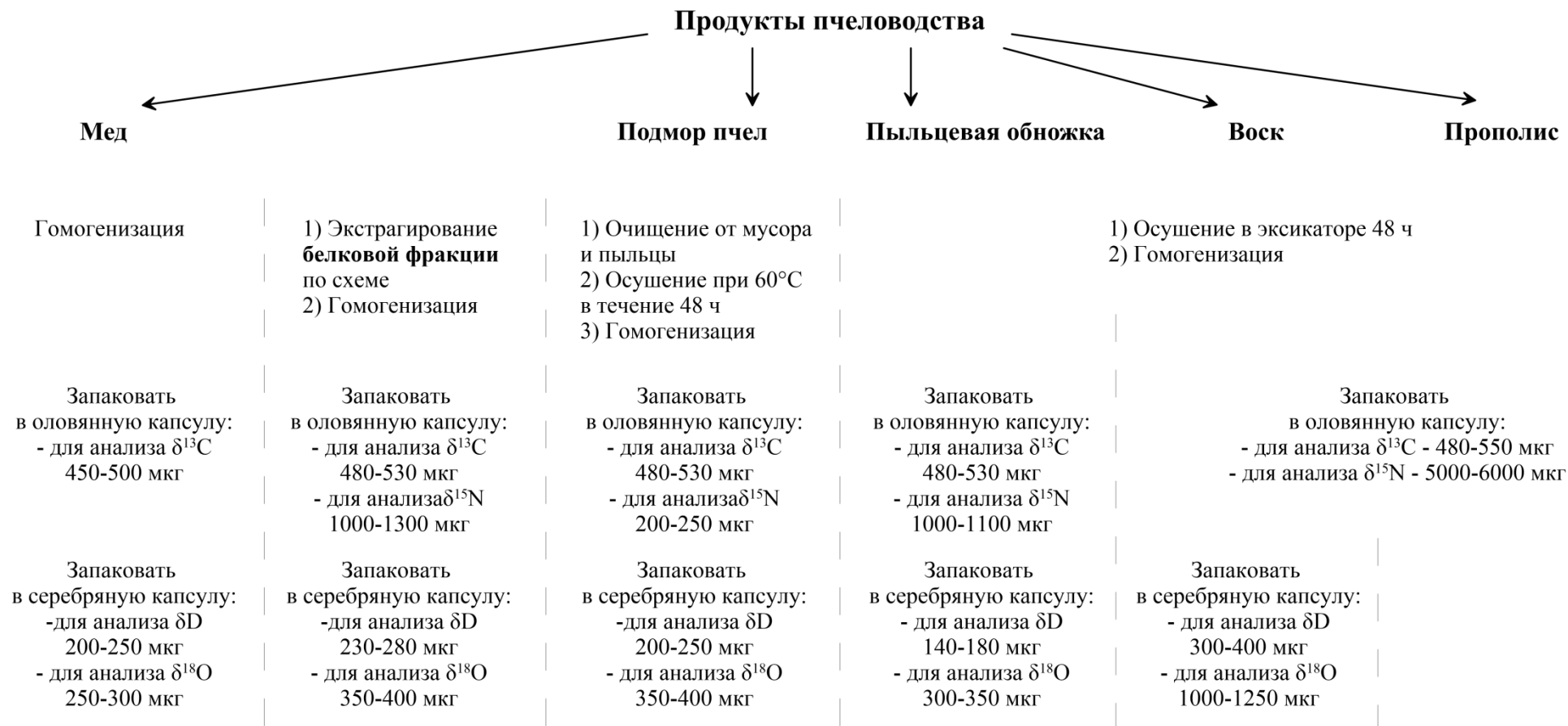
Рисунок 12 – Схема подготовки образцов продуктов пчеловодства для проведения изотопного анализа
