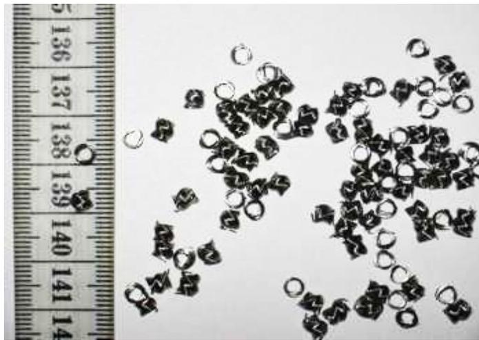
Рисунок 6.3 – Вид спиральнопризматической насадки из нихрома
