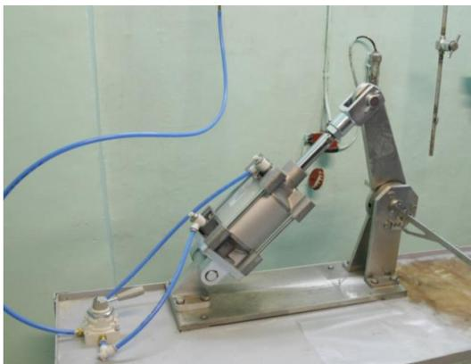
Рисунок 2.3 – Ножницы пневматические
