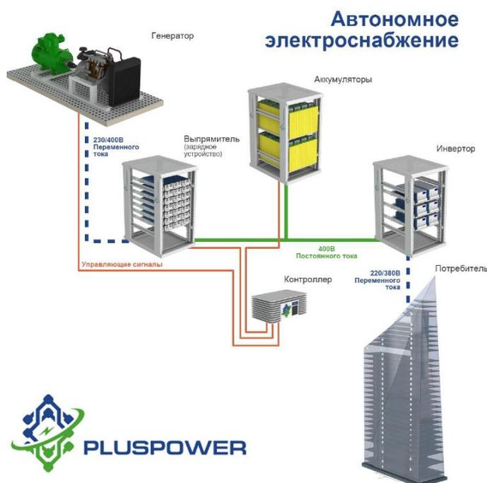
Рисунок 8 – Концепция построения системы автономного электроснабжения от ООО «Pluspower»
