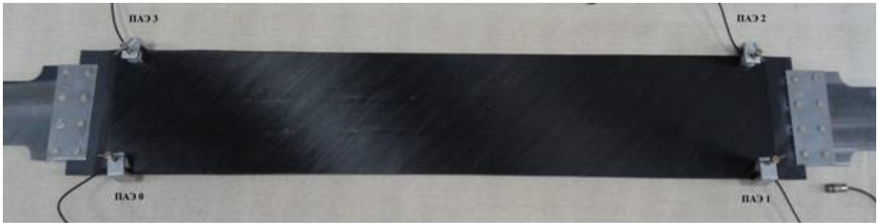
Рисунок 2.12 — Образец из углепластика T700 с ПАЭ для оценки точности локации
