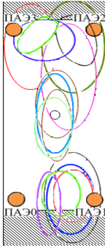
Рисунок 4.6 – Расположение кластеров сигналов АЭ при испытании образца 1 группы 3 после первого этапа кластеризации
