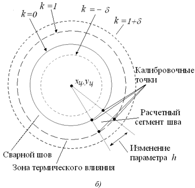
Рисунок 4.24 – Аналитическая локация сигналов калибровки нечетных секторов сварного шва (а); б - зона термического влияния сварного шва с учетом погрешности локации
