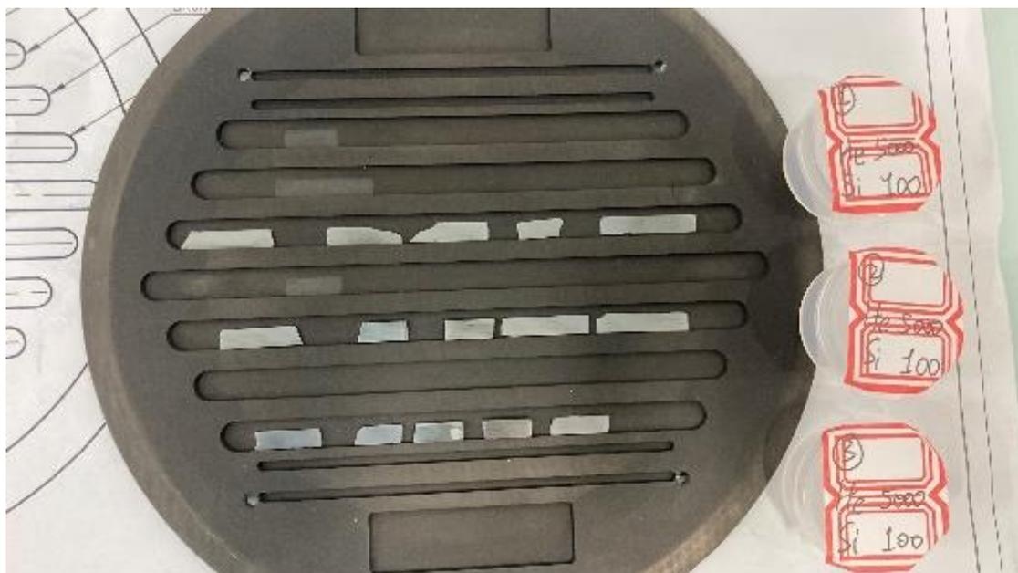
Рисунок 5.1 – На графитовом диске прорезы для размещения образцов
