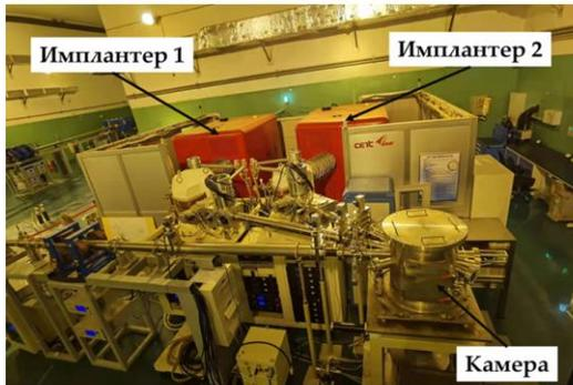
Рисунок 2.10 – Физическая фотография оборудования для ионного облучения
