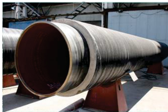
Рис. 2. Внешний вид обетонированной трубы
