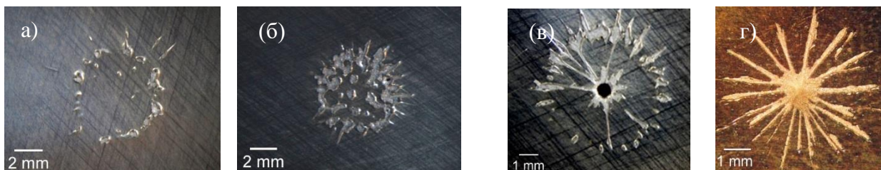
Рисунок 2 – Автографы электронного пучка, оставленные на анодах из алюминия (а, б, в) и меди (г) при использовании цилиндрического катода без полости (а, б) и пологого катода (в, г)
