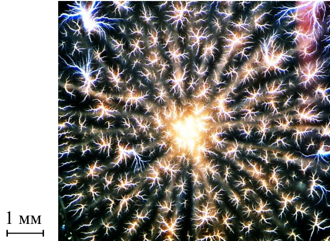
Рисунок 4.8 – Свечение каналов электрического пробоя, развивающихся в ПММА в режиме филаментации и самофокусировки электронного пучка [3]
