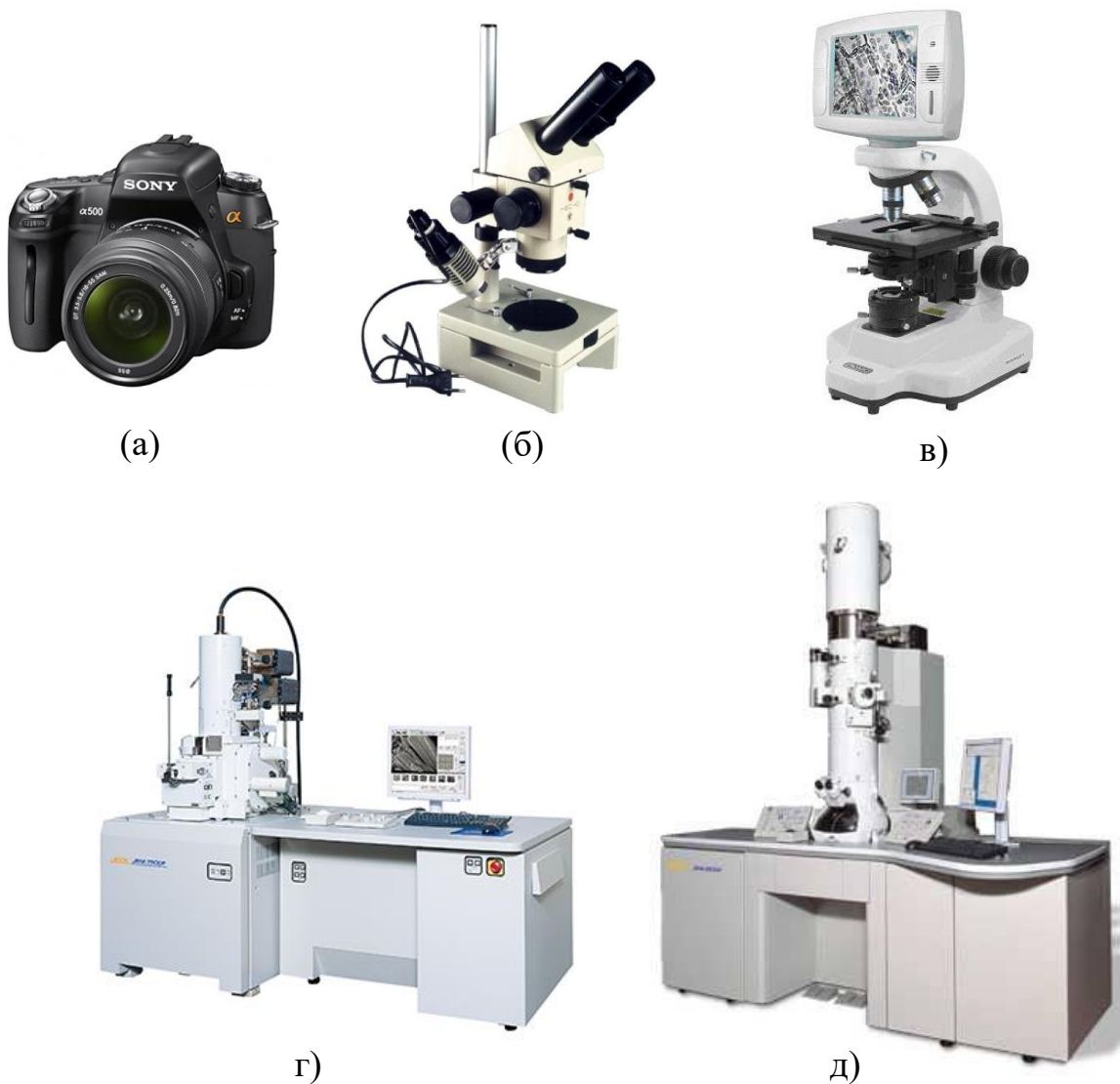
Рисунок 2.15 – Фотографии цифровой камеры SONY-DSLR A500 (а), оптического микроскопа МБС-10 (б), оптического микроскопа проходящего света \mu Vizo-101 (в), сканирующего (растрового) электронного микроскопа РЭМ JEOL JSM-7500FA (г), просвечивающего электронного микроскопа ПЭМ JEOL JEM-2100F (д)
