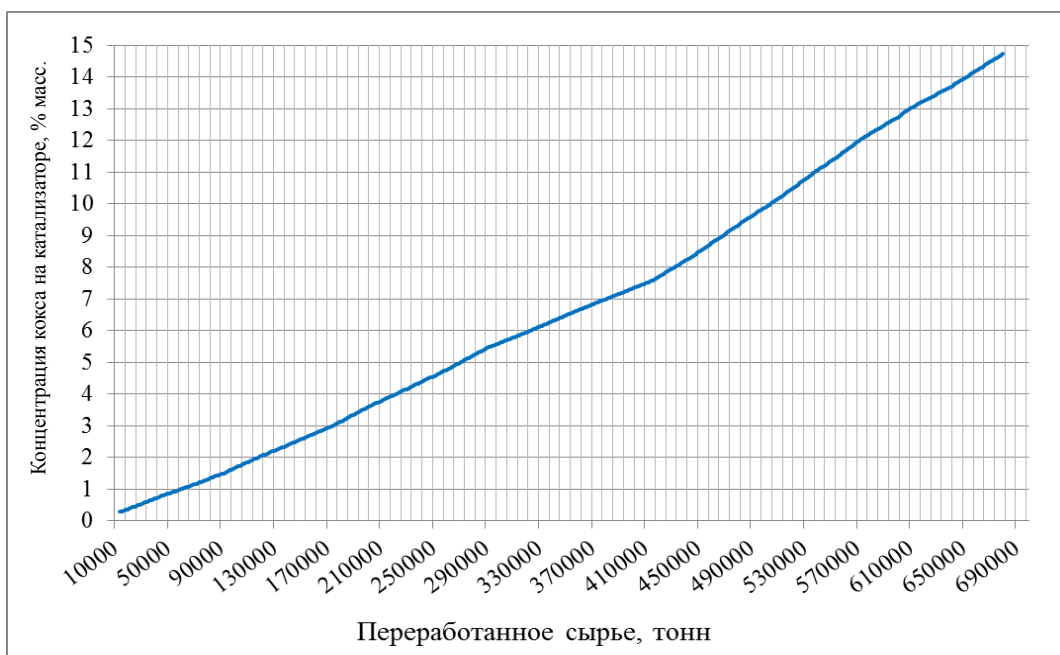
Рисунок 22 – Изменение концентрации кокса на катализаторе риформинга установки Л-35-11/600 в период 28.11.2015г. – 30.06.2017г.
