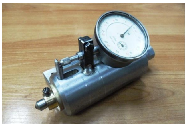
Рисунок 1.9 – Оправка с винтовой пружиной : 1 – регулировочный винт ; 2 – винтовая пружина ; 3 – индикатор часового типа ; 4 – индентор .
