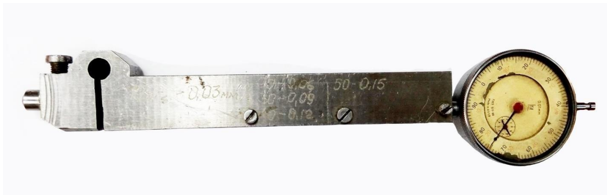
Рисунок 1.6 – Оправка с плоской пружиной имеющий конструктив типа петля
