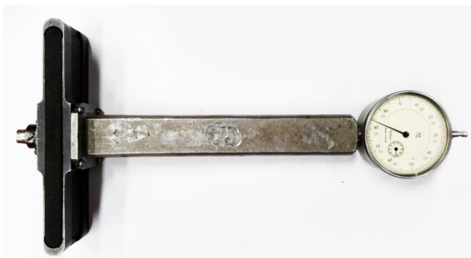
Рисунок 1.7 – Оправка для алмазного выглаживания с плоской симметричной пружиной
