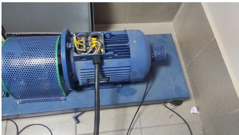
Рис. 46. Нагрузочный асинхронный двигатель
