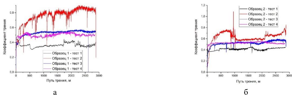
Рис. 2. Зависимость коэффициента трения от пройденного пути образца № 1 (а) и образца № 2 (б)
