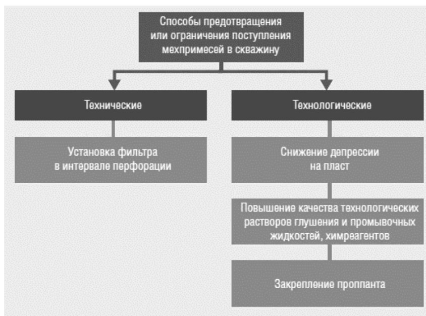
Рисунок 3 - Способы предотвращения или ограничения поступления мехпримесей в насосную установку
