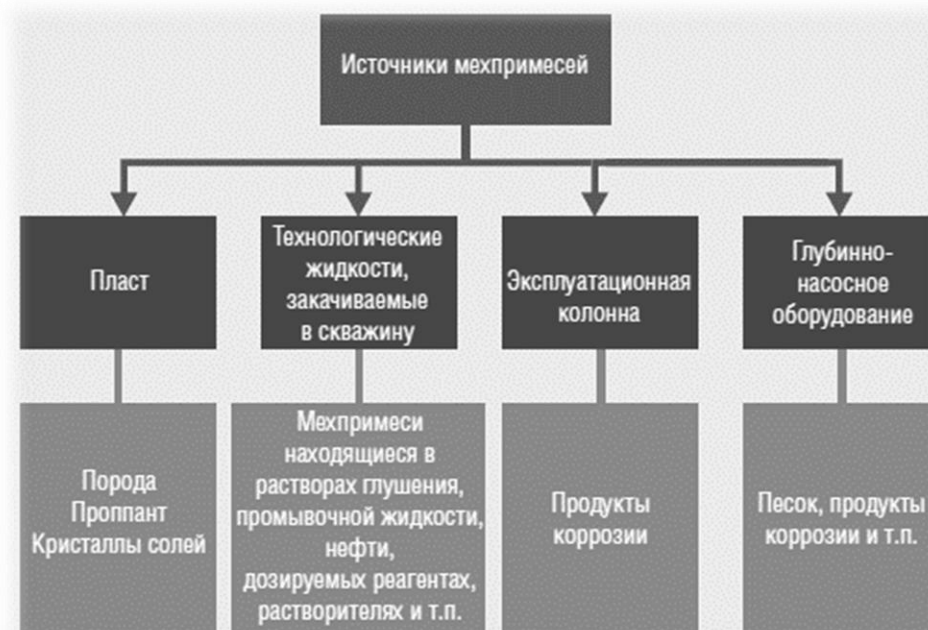
Рисунок 1 - Источники механических примесей, попадающих в насосную установку
