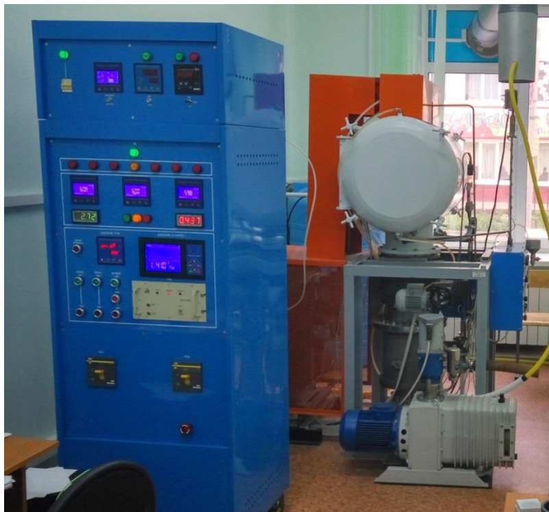
Рисунок 2.2 – Общий вид вакуумной печи СНВЭ – 1,7.3.1
