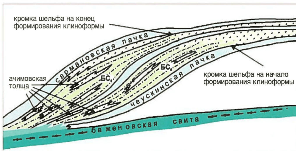
Рисунок 2.4 – Принципиальная схема строения нефтегазаносного резервуара BS 8-9 Чеускинский субрегиональный клиноциклит (Белоусов С.Л. и др., 2007)
