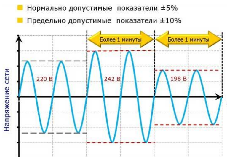
Рисунок 6.2 – Предельно допустимые отклонения напряжения сети
