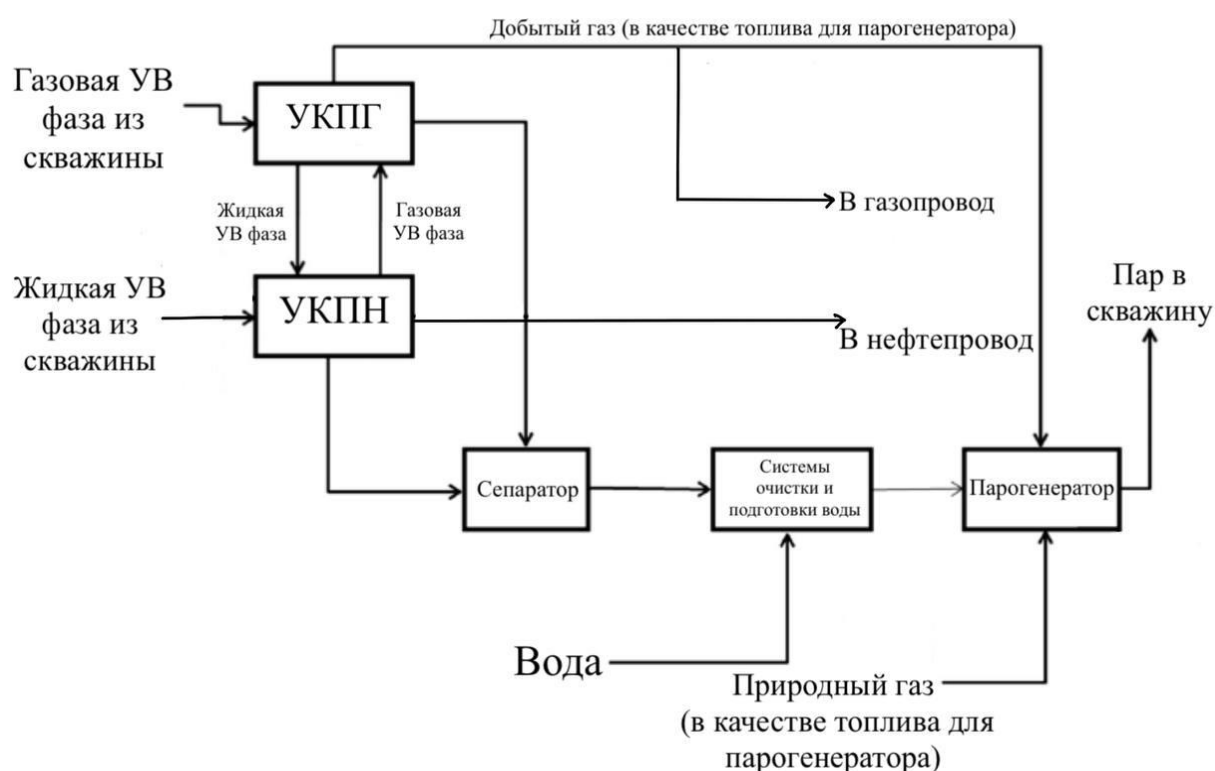
Рисунок 4.1 – Образец схемы поверхностного обустройства участка для проведения ПГД [Rui, 2018]
