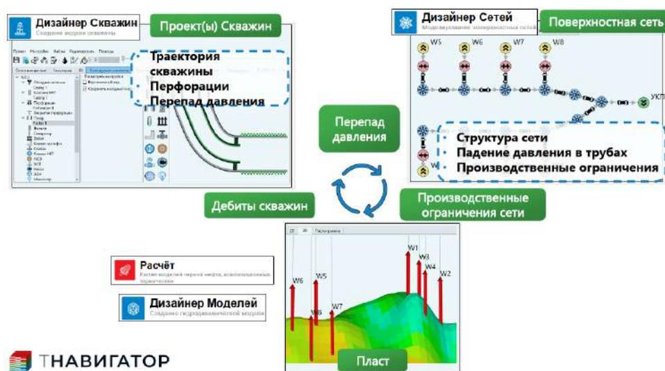
Рисунок 4.10 – Схема интеграции и движения данных в tНавигатор [26]
