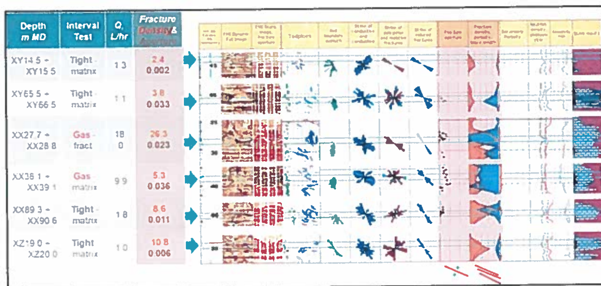
Рисунок 1.3 – Обобщенные результаты классификации трещиноватых интервалов, с использованием микроимеджеров и данных пластоиспытателя (Ramatulayev Samat, 2019)
