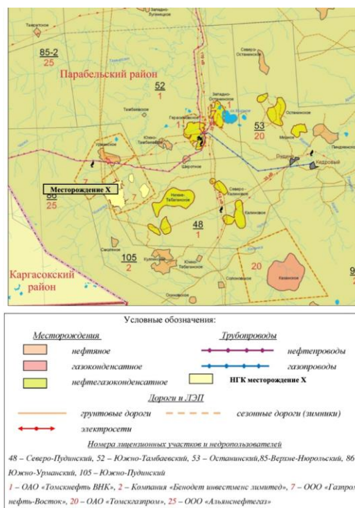
Рисунок 2.1 – Обзорная схема расположения НГК месторождения X (Лебедев Ю. Е., 2017)
