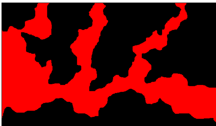
Рисунок 3.1 – Объемный гель в поровом пространстве
