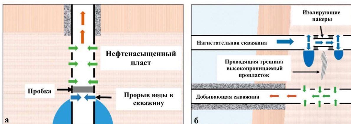
Рисунок 1.6 – Схема изоляции скважины от нежелательного прорыва воды
