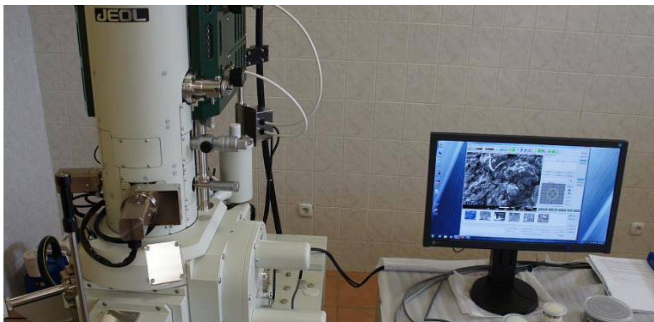
Рисунок 2.6 – Общий вид установки JEOL JSF-7800F с энергодисперсионным анализатором
