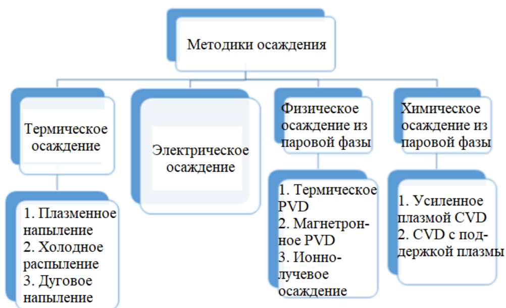
Рисунок 1.6 – Схематическая диаграмма методов осаждения тонких углеродных структур. Рисунок адаптирован из [55]
