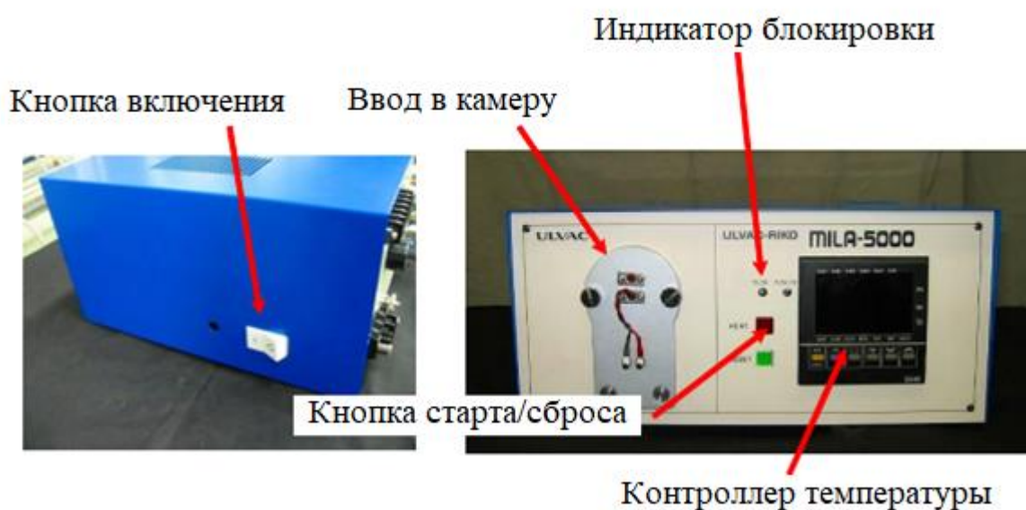
Рисунок 2.3 – Общий вид установки Mila-5000: 1) системная кнопка для запуска оборудования (кнопка включения); 2) камера для ввода образцов для проведения термообработки (ввод в камеру); 3) индикаторы блокировки/разблокировки камеры (индикатор блокировки); 4) индикатор регулятора температуры E5AR (контроллер температуры) [170]
