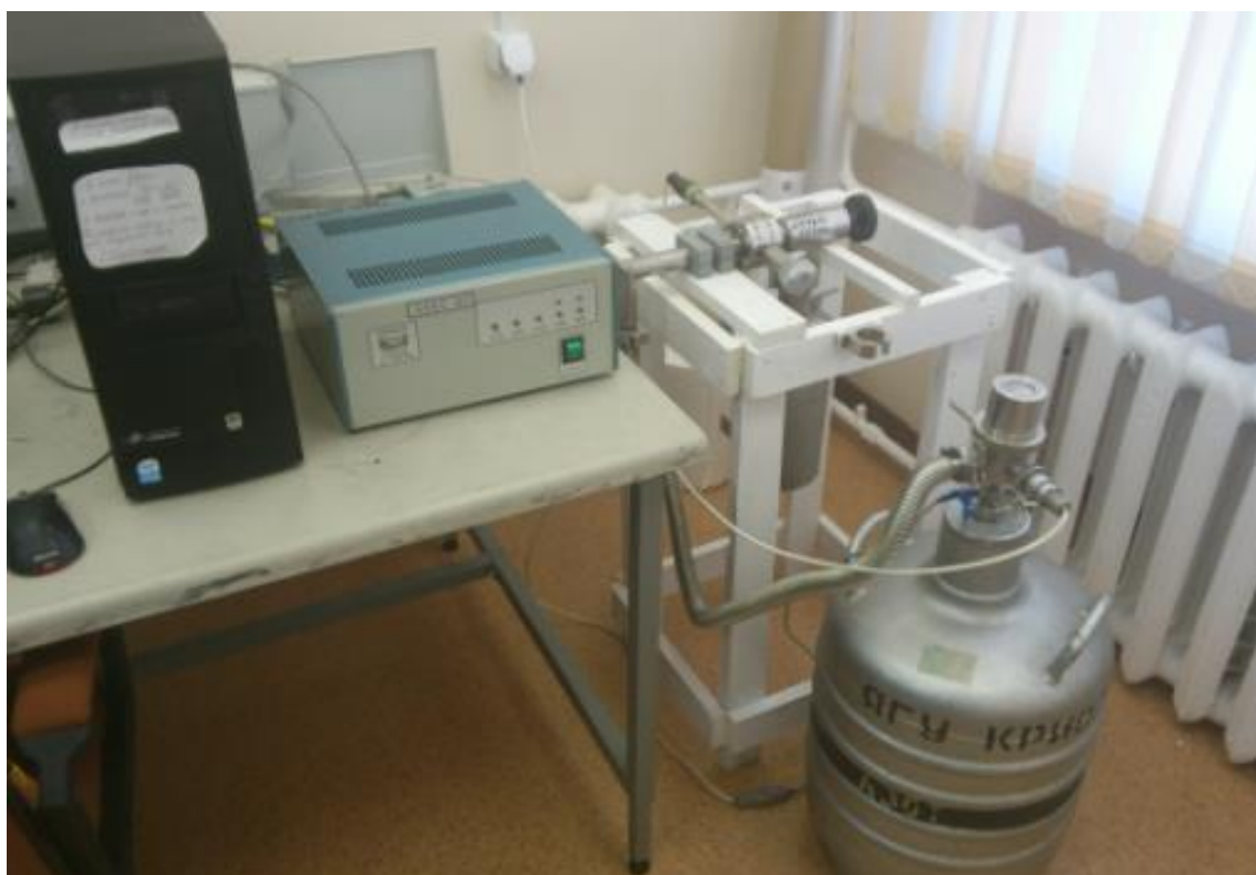
Рисунок 2.9 – Общий вид установки электрофизических измерений ASEC-03 с подключенным дьюаром для азота
