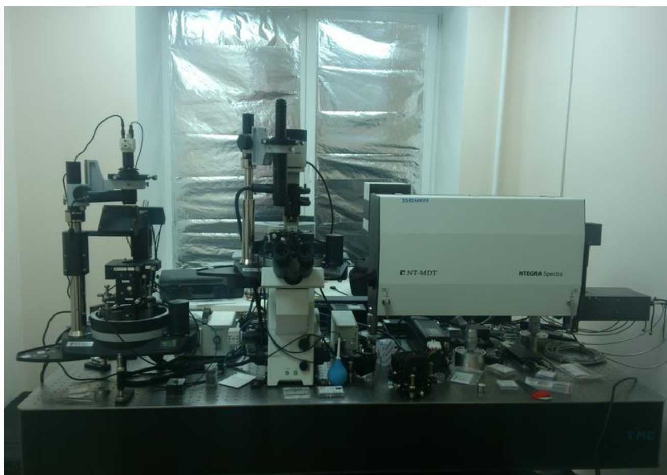
Рисунок 2.7 – Общий вид установки КРС спектроскопии NTegra Spectra компании NT-MDT без управляющего блока и мониторов
