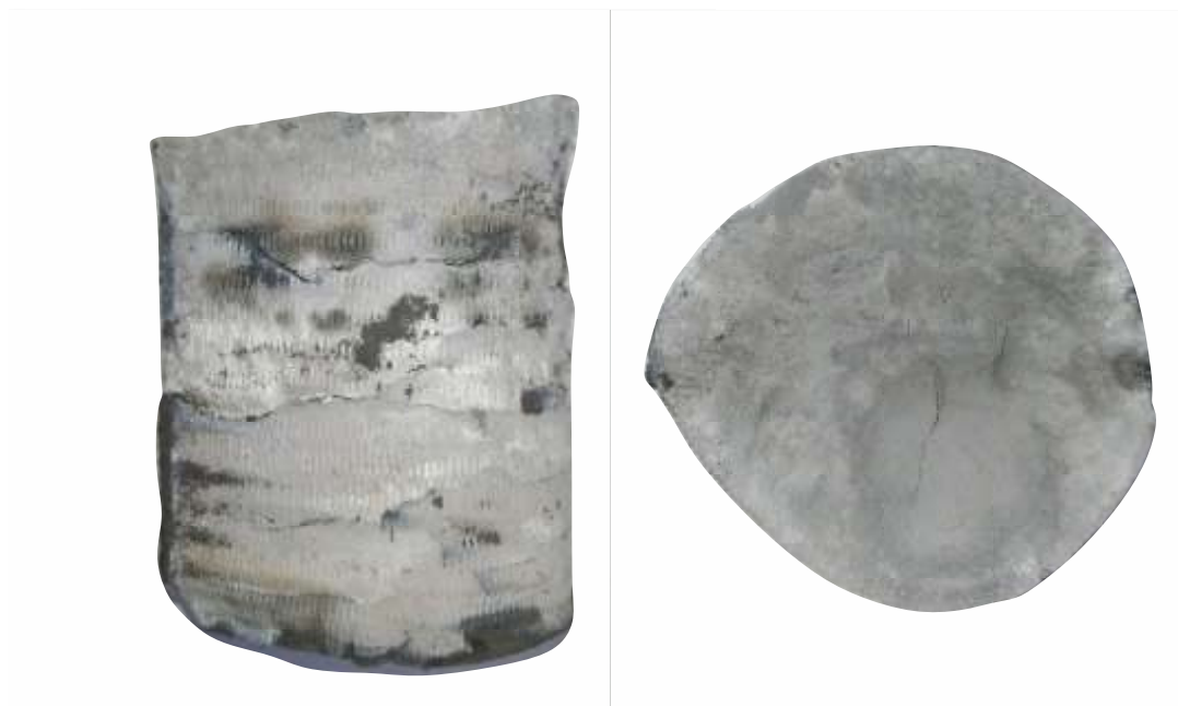
Рисунок 4.9. Фото азотированного образца композиции на основе ферросиликоалюминия (90 масс. %) и маршалита (10 масс. %).
