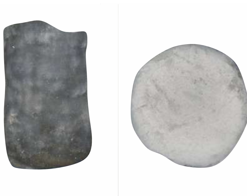
Рисунок 4.3. Фото продукта азотирования композиции ферросиликоалюминия (78 масс. %) и микрокремнезема (22 масс. %).
