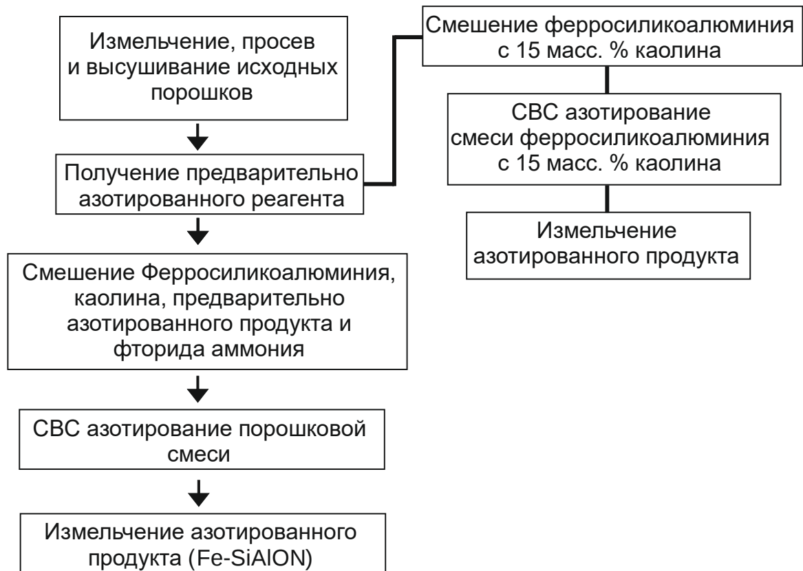
Рисунок 5.2. Технологическая схема получения сиалонсодержащего материала в режиме горения.
