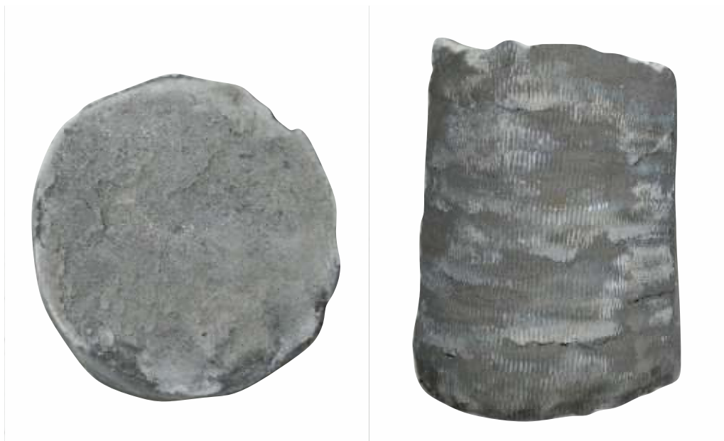
Рисунок 4.15. Фото азотированного образца смеси ферросиликоалюминия (85 масс. %) с каолином (15 масс. %).
