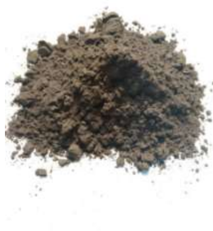
Рисунок 2.2. Фото измельченного порошка ферросиликоалюминия.
