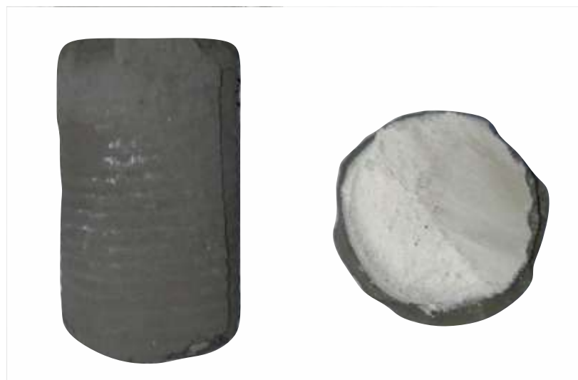
Рисунок 4.6. Фото азотированного образца композиции: ферросиликоалюминий (62,01 масс. %), микрокремнезем (17,49 масс. %), предварительно азотированный продукт (20 масс. %) и \text{NH}_4\text{F} (0,5 масс. %).
