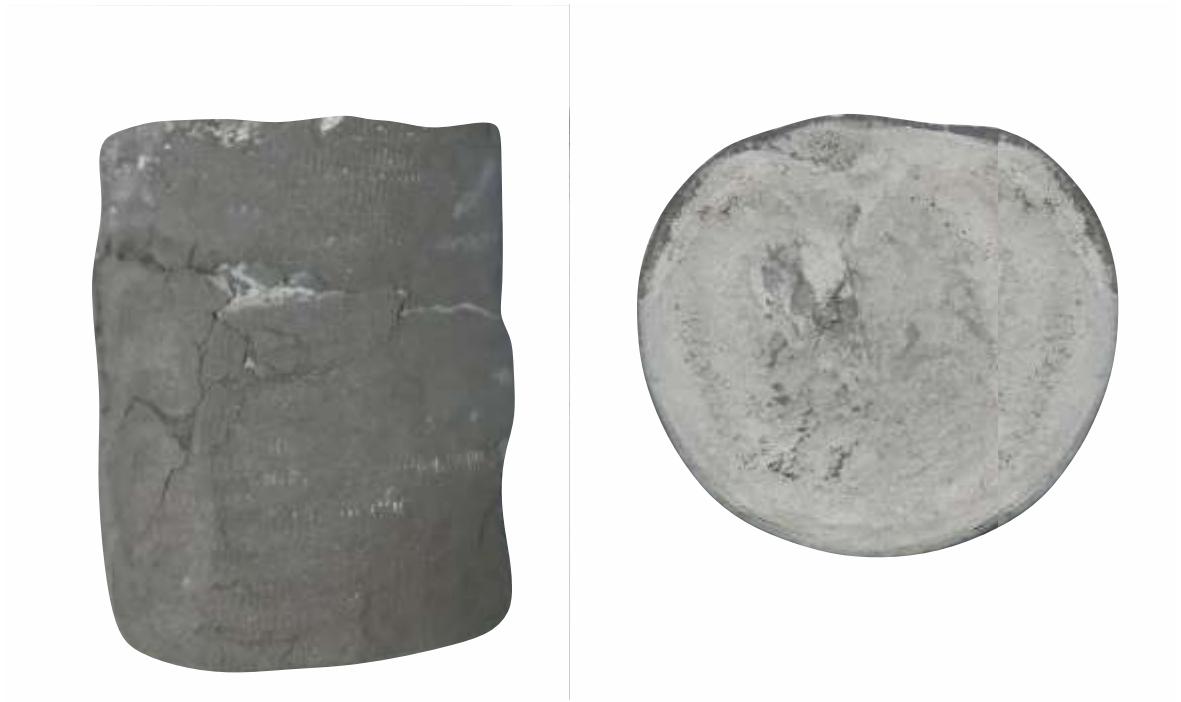
Рисунок 4.18. Фото азотированного образца на основе ферросиликоалюминия (67,15 масс. %) и каолина (11,85 масс. %) с добавками азотированного продукта (20 масс. %) и фторида аммония (1 масс. %).
