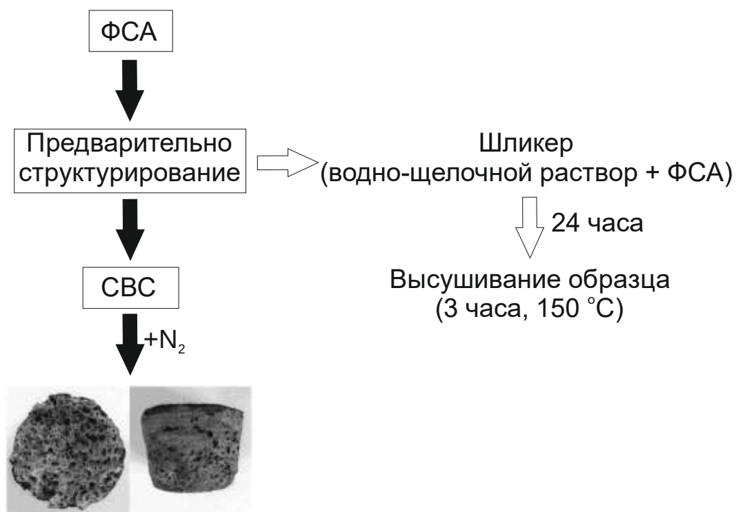
Рисунок 5.5. Схема получения пористого сиалонсодержащего материала методом СВС
