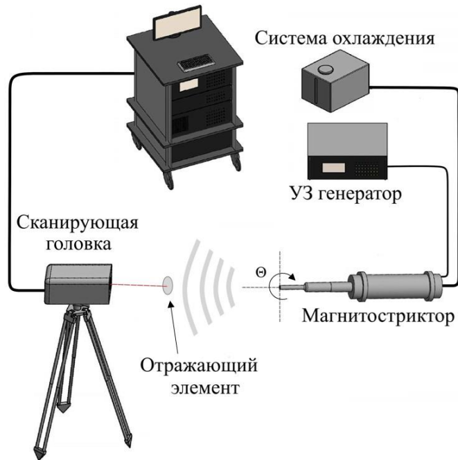
Рисунок 3.7 – Схема лабораторной установки для измерения диаграммы направленности ультразвуковых излучателей с использованием сканирующего лазерного доплеровского виброметра
