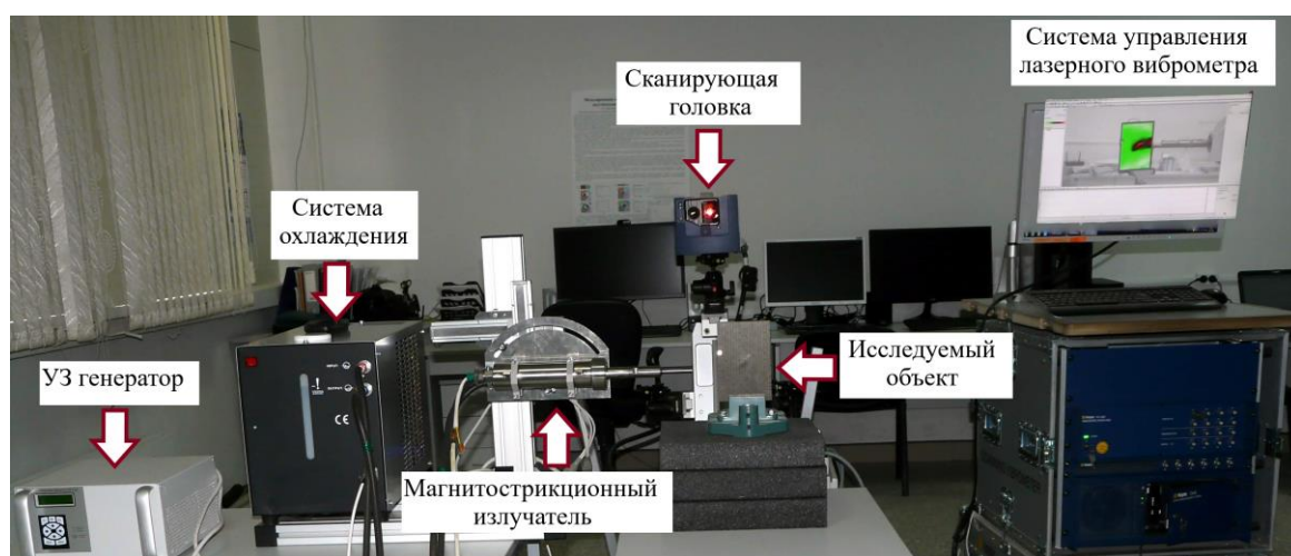
Рисунок 4.50 – Установка для неразрушающего контроля углепластикового композита с использованием воздушно-связанного магнестрикционного излучателя
