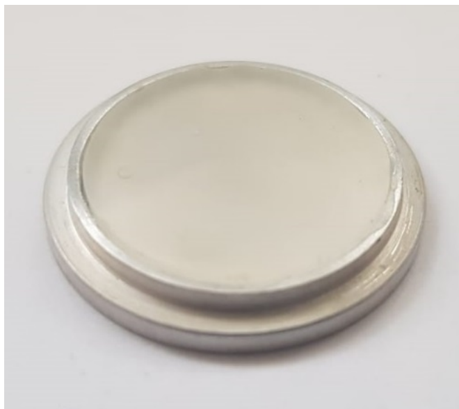
Рисунок 2.9 – Внешний вид исследуемых образцов полимеров в алюминиевой подложке
