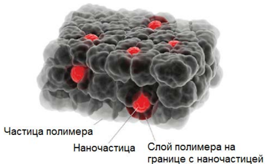
Рисунок 1.1 –Строение полимерных наноккомпозитов
