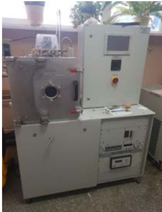
Рисунок 2.14 – Установка для напыления плёнок магнетронным и электронно-лучевым способом EPOS-PVD
