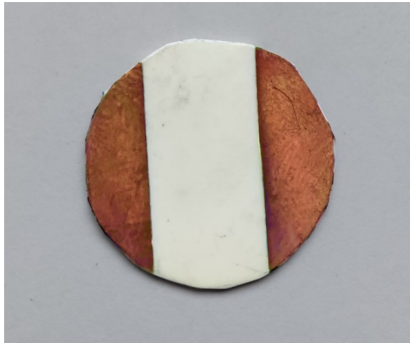
Рисунок 2.13 – Образец ПП, модифицированного наночастицами TiO_2 с напылёнными медными контактами
