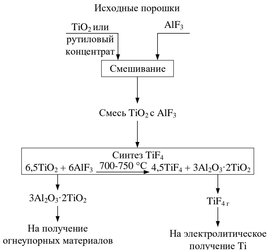
Рисунок 6.2 – Принципиальная схема линии запуска процесса для синтеза тетрафторида титана
