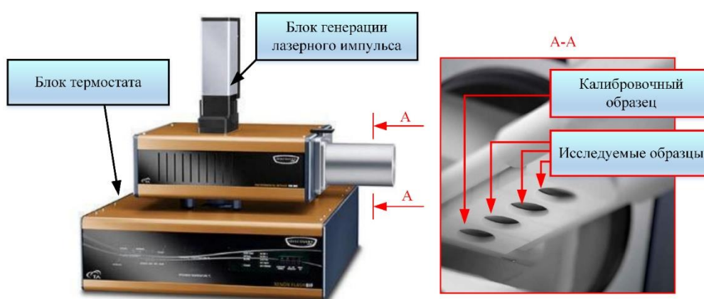
Рисунок 2.1 – Схема системы для определения теплофизических характеристик материалов [109]
