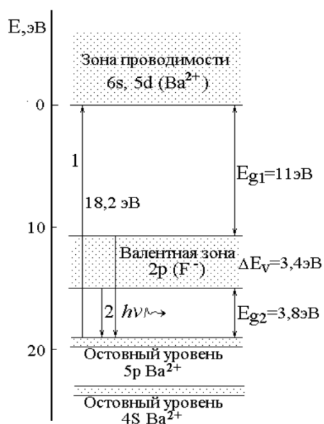
Рисунок 5 - Зонная схема кристалла \text{BaF}_2 и возникновение кросс-люминесценции [16].
