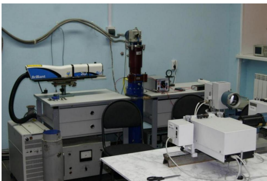
Рисунок 27 - Общий вид установки для измерения спектров поглощения при низких температурах
