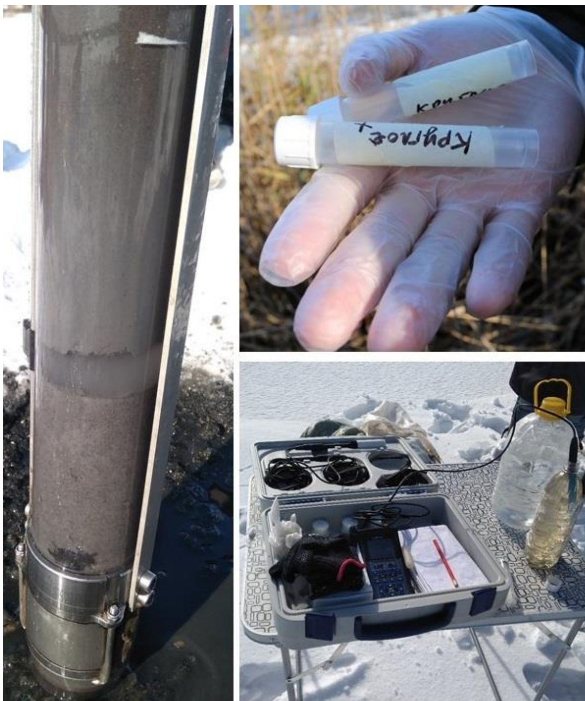
Рисунок 3.1 – Процесс отбора проб донных отложений и воды на исследуемых водоемах
