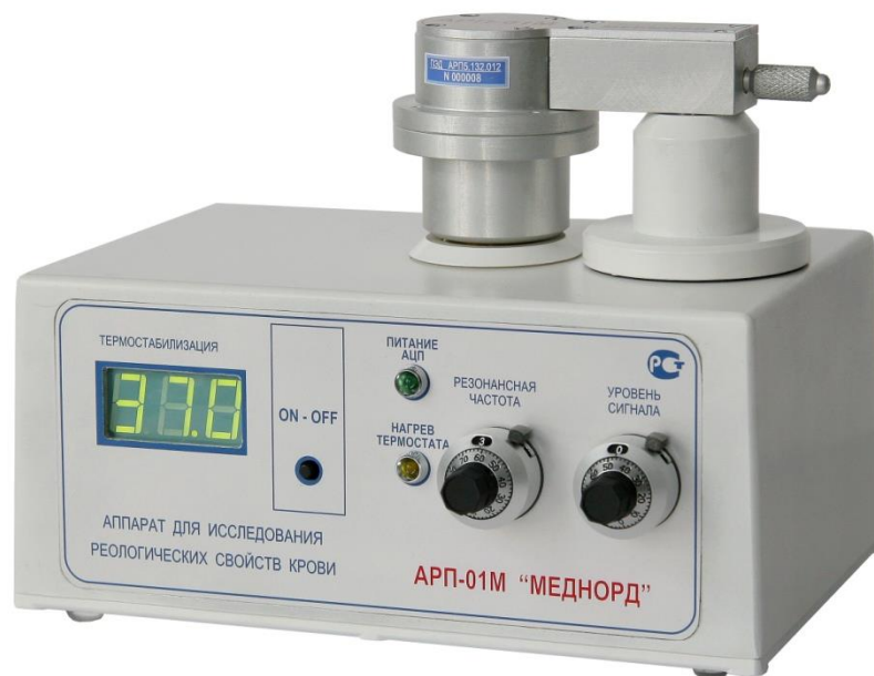
Рисунок 10. АРП-01М «Меднорд» – технология низкочастотной пьезотромбоэластографии [93]
