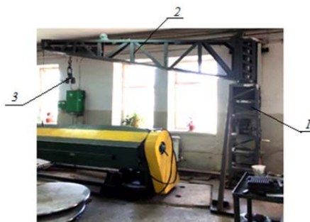
Рис. 2. Консольный поворотный подъемный механизм с ручным приводом:
