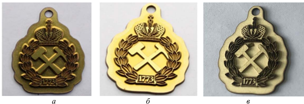
Рис. 5. Значок с логотипом Горного Университета после лазерного полирования многостадийной методикой. а – освещение сверху, б – освещение сбоку, в – Значок с логотипом Горного Университета после лазерного полирования одностадийной методикой
