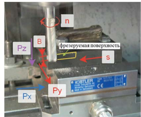
Рис. 10. Направление составляющих силы резания, отображающихся на мониторе динамометра Kistler, и направление подачи s (мм/мин) при встречном фрезеровании подложки концевой фрезой
