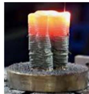
Рис. 4. Создание детали методом наплавления с использованием проволоки
