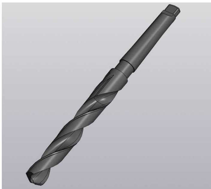
Рис. 3. Твердотельная модель сверла 2301-0069 ГОСТ 10903-77
