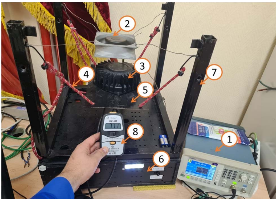
Рис. Схема стенда для проведения вибрационных испытаний: 1 – генератор частот; 2 – куллер; 3 – низкочастотный вибрационный динамик; 4 – трос-демпфер; 5 – площадка фиксации образца; 6 – усилитель частот; 7 – стальная рама; 8 – виброметр ВК-5М
