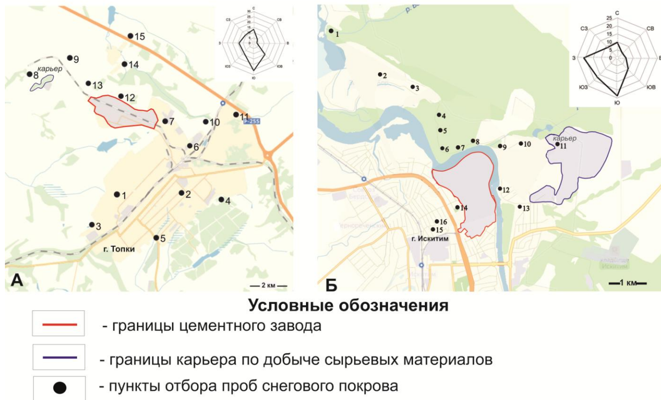
Рисунок 3.1.1 – Карта-схема отбора проб снегового покрова в окрестностях цементных заводов юга Западной Сибири: а – г. Топки; б – г. Искитим (google-карты с дополнениями автора)
