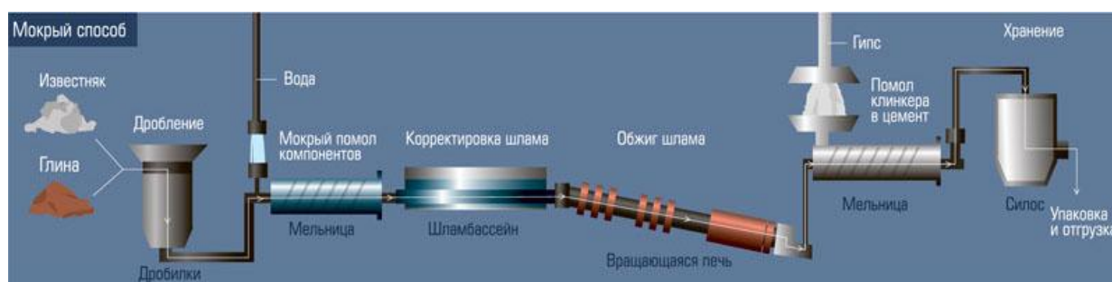
Рисунок 2.4.1 – Схема производства цемента по «мокрому» способу (Штарк, 2008)
